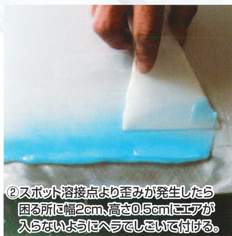
ご覧のように熱を加えても吸収している 為、手で持てます。(マネしないで下さい)
