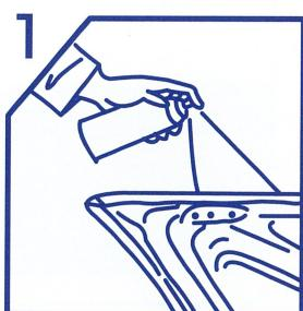
交換パネルに足付けをし、ラッカーシンナー等で十分に脱脂をして下さい。
