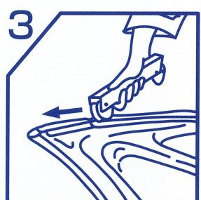
貼り付け後、専用ローラーで圧着し、空気をしっかり抜いて下さい。
